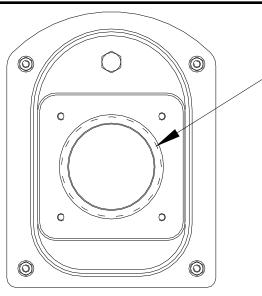
TRIM INSULATION IN BOILER DOOR OPENING TO 4.25" FOR BECKETT AFG BLAST TUBE.
